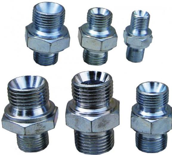
Raccord à visser filetage au pas gaz. Ce raccord est idéale pour effectuer différents montage HP. Ce raccord sur la partie mâle est équipé d'un cône de 60° pour l'étanchéité parfaite du flexible HP qui est raccordé.
